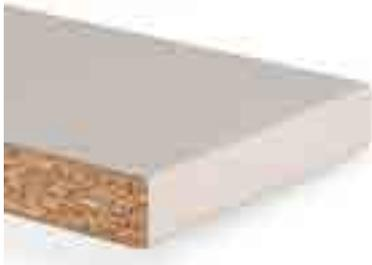
Arbeitsplatte aus einer Holzspanplatte Typ P2 gemäß EN 312, Dekorseite belegt mit Duropol HPL, Duropol XTreme bzw. Duropol XTreme Touch, Unterseite mit wasserabweisendem Gegenzug. Die Postforming-Vorderkante der Arbeitsplatte Quadra besitzt einen Radius von 3 mm, die Hinterkante ist mit einer Schutzkante versiegelt. Als Variante ist sie auch beidseitig profiliert erhältlich. Duropol XTreme sowie Duropol XTreme Touch sind ein attraktives Supermatt-Oberflächenmaterial mit Anti-Fingerprint-Effekt.
