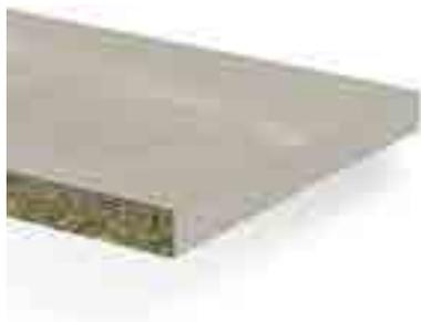
Arbeitsplatte aus einer Holzspanplatte Typ P3 für den Feuchtbereich, Dekorseite belegt mit Duropol HPL bzw. Duropol XTreme, Unterseite mit wasserabweisendem Gegenzug. Die beiden Längskanten der Arbeitsplatte PerForm sind mit einer Laserkante versehen. Als Variante ist sie an der Hinterkante auch mit einer Schutzkante versiegelt erhältlich. Duropol XTreme ist ein attraktives Supermatt-Oberflächenmaterial mit Anti-Fingerprint-Effekt.
