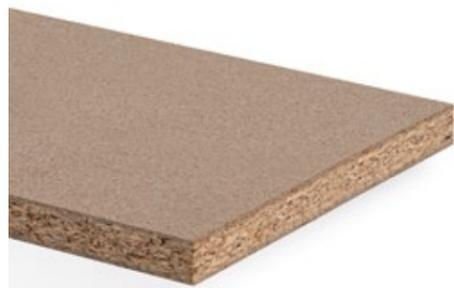
Panneau de particules de bois de type P5 conforme à la norme DIN EN 312 convenant aux applications porteuses dans des conditions humides et nécessitant une résistance accrue et constante à la vapeur d'eau.
