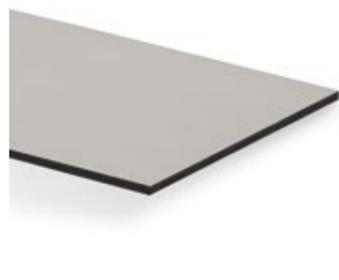
Panneau stratifié compact pour l'extérieur en qualité ignifuge conformément à la norme EN 438-6:EDF / pour les décors intensifs conformément à la norme EN 438-6:EGF. Composé d'un noyau noir homogène, revêtu d'une laque acrylique décorative sur la face supérieure, la contreface sera revêtue d'une résine mélaminée décorative.
