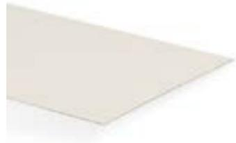
Elektrostatisch ableitender Hochdruckschichtstoff in Postforming-Qualität in Anlehnung an EN 438-3:HGP/VGP, mit strapazierfähiger Melaminharzoberfläche und geschliffener Rückseite.
