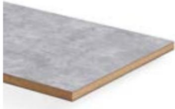
Nischenrückwand aus einer mitteldichten Faserplatte (MDF) mit homogenem Aufbau, beidseitig belegt mit Duropol XTreme, einem attraktiven Supermatt-Oberflächenmaterial mit Anti-Fingerprint-Effekt.
