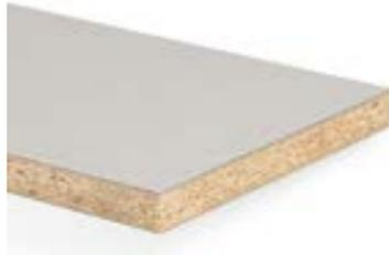
Verbundelement aus einer Holzspanplatte Typ P2 gemäß EN 312, mit 100 % biogenem, formaldehydfreiem Leim (OrganicGlue) und 100 % Recyclingholz, beidseitig belegt mit Duropol HPL Echtmetall.
