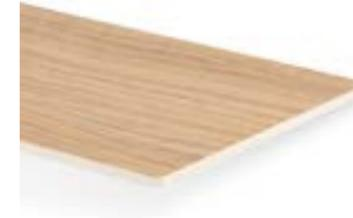
Brandschutzplatte der IMO-Einstufung „Low Flame-Spread Surface Material“ aus primär mineralischen Bestandteilen, mit homogen weiß gefärbtem Kern und beidseitig dekorativer Melaminharzoberfläche.
