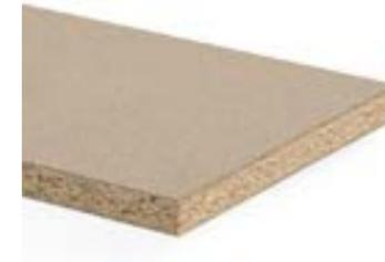
Mit 100 % biogenem, formaldehydfreiem Leim (OrganicGlue) gebundene Holzspanplatte mit einem Recyclingholzanteil von 100 % Typ P2 gemäß EN 312, geeignet für nicht tragende Zwecke im Trockenbereich.
