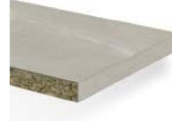
Arbeitsplatte aus einer Holzspanplatte Typ P3 für den Feuchtbereich, Dekorseite belegt mit Duropal HPL bzw. Duropal XTreme, Unterseite mit wasserabweisendem Gegenzug. Die beiden Längskanten der Arbeitsplatte PerForm sind mit einer Laserkante versehen. Als Variante ist sie an der Hinterkante auch mit einer Schutzkante versiegelt erhältlich. Duropal XTreme ist ein attraktives Supermatt-Oberflächenmaterial mit Anti-Fingerprint-Effekt.
