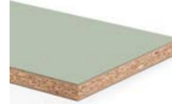
Verbundelement aus einer Holzspanplatte Typ P2 gemäß EN 312, mit 100 % biogenem, formaldehydfreiem Leim (OrganicGlue) und 100 % Recyclingholz, beidseitig belegt mit Duropal HPL.
