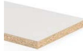
Emissionsminimierte melaminbeschichtete Holzspanplatte Typ P2 gemäß EN 312, mit hochwertiger und innovativer Hochglanz-Mehrschicht-Lackierung bestehend aus einer dauerelastischen Funktionsschicht für vertikale Anwendungen.
