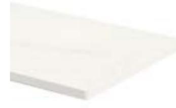
Compact-Hochdruckschichtstoff mit ein- bzw. beidseitig bearbeiteter Längskante in Standard-Qualität gemäß EN 438-4:CGS bzw. EN 438-9:BCS für den Einsatzzweck als Arbeitsplatte. Mit homogen schwarz, grau oder weiß gefärbtem Kern, einseitig dekorativer Melaminharzoberfläche und Gegenzug.
