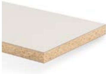
Hochbelastbares Verbundelement mit isotroper Biegefestigkeit aus einer Holzspanplatte MFP Typ P5 nach EN 312 als Mittellage und jeweils einer hochverdichteten dünnen Faserplatte (HDF) gemäß EN 622-1 als Deckschicht, beidseitig belegt mit Duropal HPL. Die innovative Holzwerkstoffkombination bietet höchste Stabilität bei optimaler Flächenruhe.
