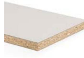
Verbundelement aus einer Holzspanplatte Typ P2 gemäß EN 312, beidseitig belegt mit Duropal XTreme plus, einem attraktiven Supermatt-Oberflächenmaterial mit Anti-Fingerprint-Effekt, welches ideal für horizontal, stark beanspruchte Flächen geeignet ist.
