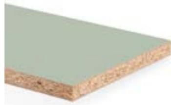
Melaminbeschichtete Holzspanplatte Typ P2 gemäß EN 312, mit 100 % biogenem, formaldehydfreiem Leim (OrganicGlue), 100 % Recyclingholz sowie hochwertiger und innovativer matten Mehrschicht-Lackierung bestehend aus einer dauerelastischen Funktionsschicht und Anti-Finger-print-Effekt für vertikale Anwendungen.
