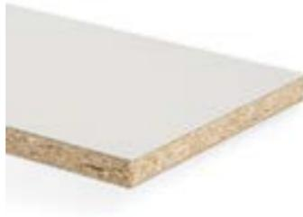
Verbundelement aus einer Holzspanplatte Typ P2 gemäß EN 312, beidseitig belegt mit Duropal SolidColor XTreme, einem durchgehend dekoridentisch gefärbten Schichtstoffkern und attraktiven Supermatt-Oberflächenmaterial mit Anti-Fingerprint-Effekt.
