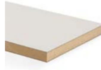
Verbundelement aus einer mitteldichten Faserplatte (MDF) mit homogenem Aufbau, beidseitig belegt mit Duropal HPL.
