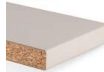
Arbeitsplatte aus einer Holzspanplatte Typ P2 gemäß EN 312, Dekorseite belegt mit Duropal HPL, Duropal XTreme bzw. Duropal XTreme Touch, Unterseite mit wasserabweisendem Gegenzug. Die Postforming-Vorderkante der Arbeitsplatte Quadra besitzt einen Radius von 3 mm, die Hinterkante ist mit einer Schutzkante versiegelt. Als Variante ist sie auch beidseitig profiliert erhältlich. Duropal XTreme sowie Duropal XTreme Touch sind ein attraktives Supermatt-Oberflächenmaterial mit Anti-Fingerprint-Effekt.
