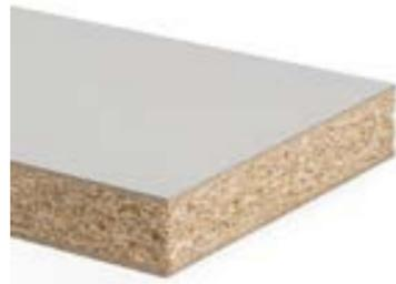
Arbeitsplatte aus einer Holzspanplatte Typ P2 gemäß EN 312, Dekorseite belegt mit Duopal HPL, Duopal XTreme, Duopal XTreme Touch bzw. Duopal XTreme plus, Unterseite mit wasserabweisendem Gegenzug. Die Längskanten der Arbeitsplatte sind gefräst. Als Variante ist sie auch einseitig mit einer Schutzkante erhältlich. Duopal XTreme, Duopal XTreme Touch sowie Duopal XTreme plus sind ein attraktives Supermatt-Oberflächenmaterial mit Anti-Fingerprint-Effekt.
