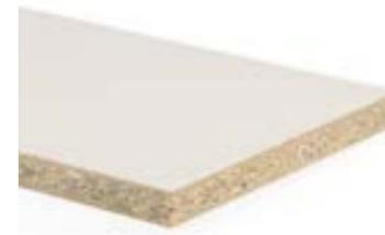
Melaminbeschichtete Holzspanplatte Typ P3 für den Feuchtbereich, mit hochwertiger und innovativer Hochglanz-Mehrschicht-Lackierung bestehend aus einer dauerelastischen Funktionsschicht für vertikale Anwendungen.
