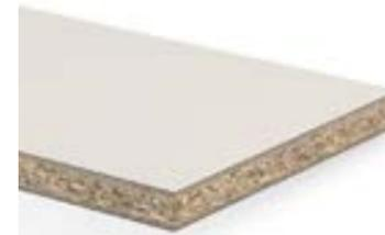
Elektrostatisch ableitendes Verbundelement aus einer ESA-Holzspanplatte Typ P2 gemäß EN 312, beidseitig belegt mit Duopal HPL ESA.
