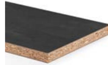
Verbundelement aus einer Holzspanplatte Typ P2 gemäß EN 312, beidseitig belegt mit Duopal XTreme Touch, einem attraktiven Supermatt-Oberflächenmaterial mit Anti-Fingerprint-Effekt in Kombination mit natürlich anmutender Stein- oder Holzstruktur.
